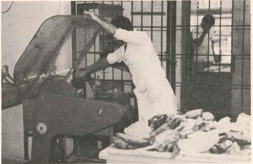
Laboratorio de preparaciones petrográficas. Aquí una cortadora automática de rocas con sierra de diamantes.
