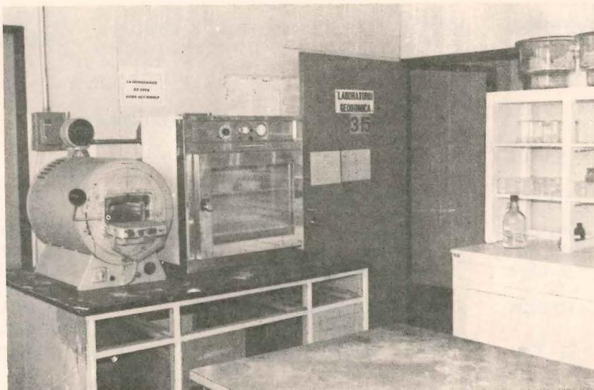
Laboratorio de Geoquímica. Hornos utilizados en el secado y fusión de muestras.
