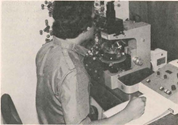
Microscopio de alta resolución (Orthoplan, Pol) con platina universal empleado para la investigación
